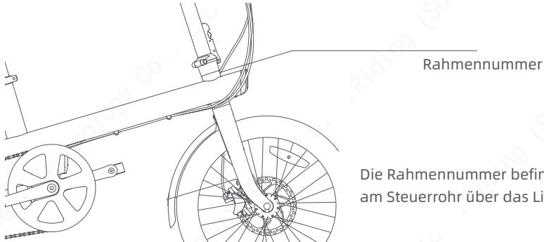
Die Rahmennummer befindet sich am Steuerrohr über das Licht.
