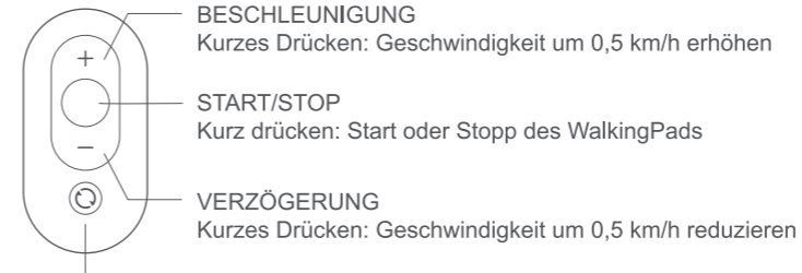
MODUS-SCHALTER Kurzes Drücken: Umschalten in den Automatikbetrieb. Langer Druck: in den Standby-Modus wechseln.
